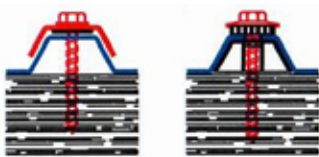
Profil 70/18 Befestigung Dach
